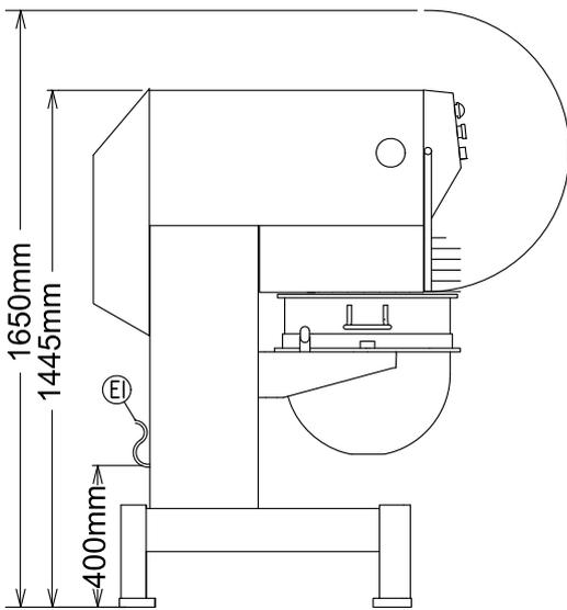
EI = Conexión eléctrica (energía)
